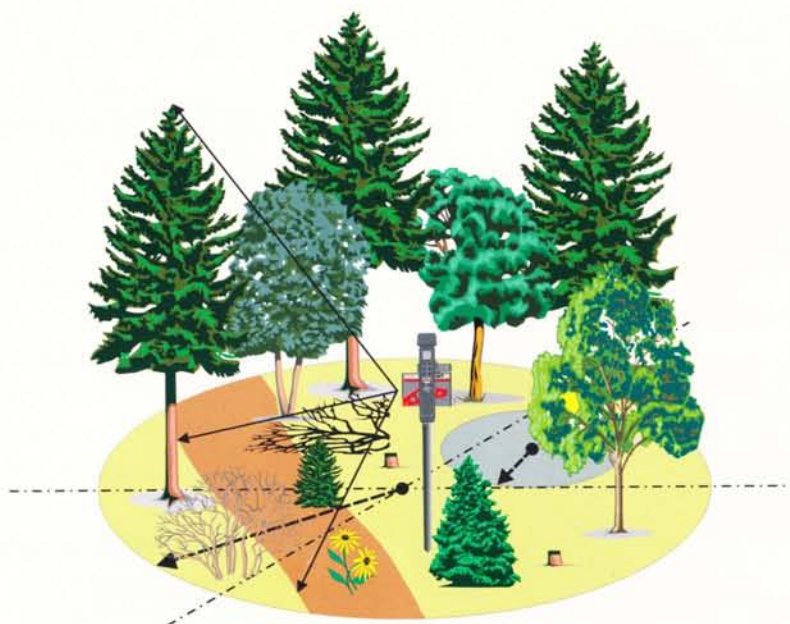
Schéma inventarizační plochy se subplochou (hnědá plocha) a obnovním kruhem (šedý kruh).
