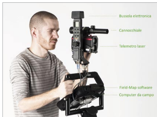
Figura 3 - La configurazione hardware tipicamente utilizzata per gli inventari forestali.
